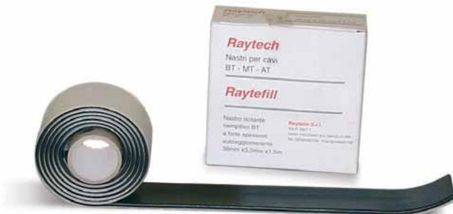
Nastro autoagglomerante isolante per bassa tensione specificatamente studiato, grazie al forte spessore (3,2 mm), per una rapida ricostruzione dell'isolante di cavi di bassa tensione, per la copertura di forme complesse (isolamento e rivestimento di giunti tra sbarre e relativi bulloni, morsetti,
