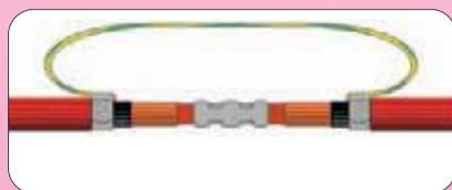
1. Preparazione dei cavi e connessione dei conduttori e degli schermi.
