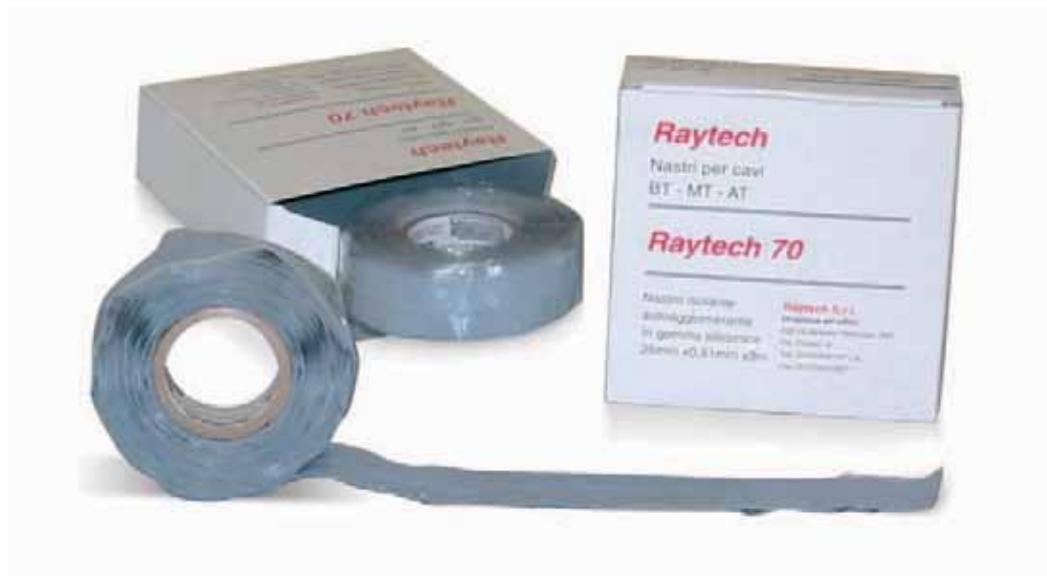
Nastro isolante autoagglomerante in gomma siliconica. Impiegato per la copertura di terminali di media e alta tensione su cavi estrusi fino a Um 72 kV, dato l'ottimo comportamento alla tracciatura elettrica in ambienti umidi o inquinati, alla corro-
