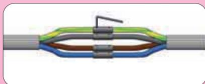
1. Preparazione dei cavi e connessione dei conduttori.
