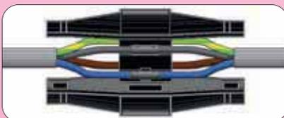
2. Inserimento dello spaziatore e centratura nel giunto; chiusura del giunto.
