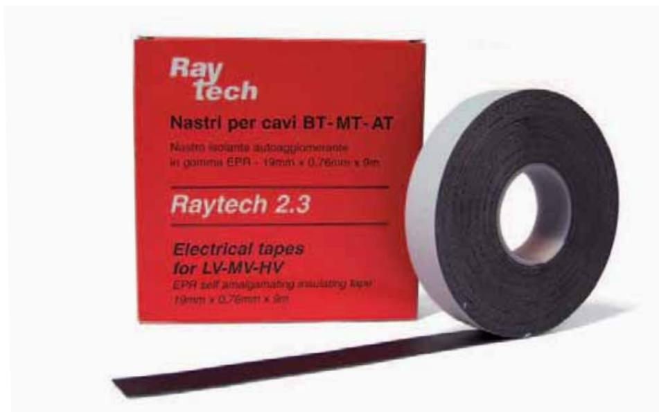
Nastro isolante autoagglomerante per alta tensione a base etilen-propilenica (EPR). Impiegato per l'isolamento e la sigillatura di connessioni elettriche anche per tensioni elevate (fino a Um 72 kV), amalgama rapidamente adattandosi al manufatto sottostante formando un corpo compatto, senza
