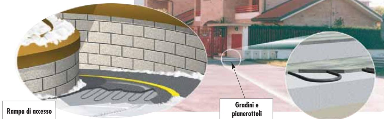
Il cavo scaldante autoregolante può essere impiegato per innumerevoli altre applicazioni in campo civile e industriale: nei tracciamenti di grondaie e falde di tetti (vedi figura) per mantenerli sgombri da neve o ghiaccio, come antigelo in impianti antincendio, di acqua potabile o reflua, per mantenere sgelate vasche,
