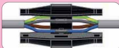
2. Inserimento dello spaziatore e centratura nel giunto; chiusura del giunto.
